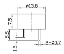
HOUSING MATERIAL: NORYL WAVE SOLDER AND WASH ALLOWED.
